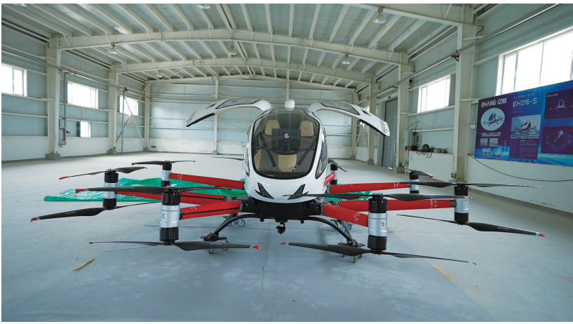
新疆恒美亿航智能有限公司生产的载人级无人驾驶电动垂直起降航空器。
